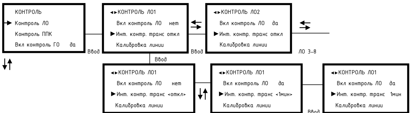
Рисунок 24. Установка интервалов контроля ЛО при трансляции.
