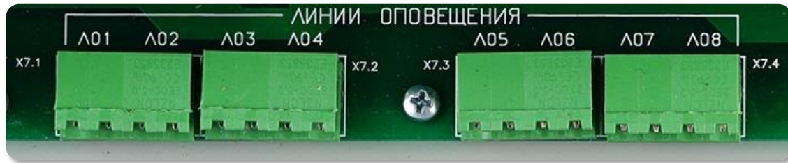
Рисунок 11. Клеммы для подключения речевых оповещателей.
