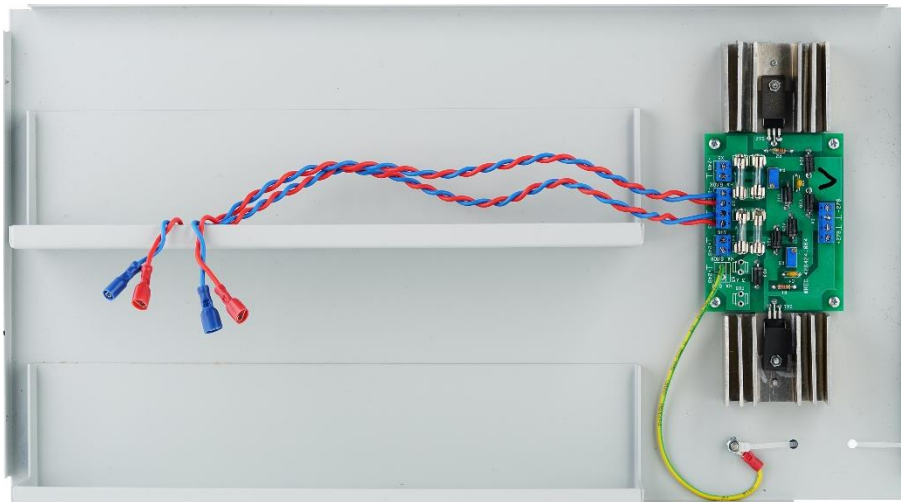
Рисунок 14. Места для установки АКБ в корпус БРП.
