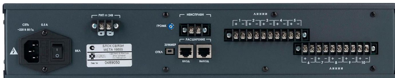
Рисунок 4. Расположение элементов коммутации (клемм и разъемов) на задней панели БС МЕТА 19555.
