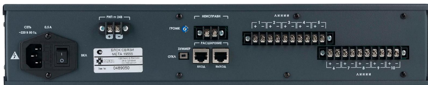
Рисунок 3. Расположение элементов коммутации (клемм и разъемов) на задней панели БР МЕТА 19556.
