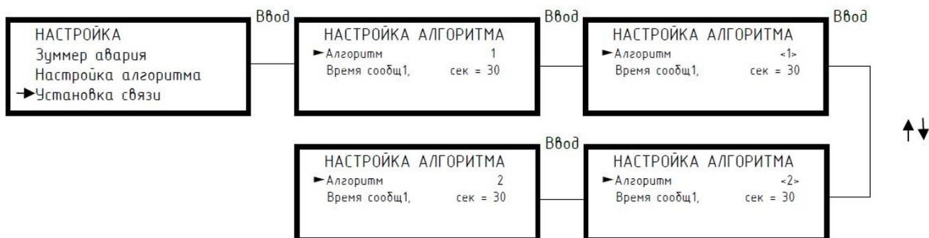
Рисунок 28. Установка алгоритма работы в режиме ПУСК.
