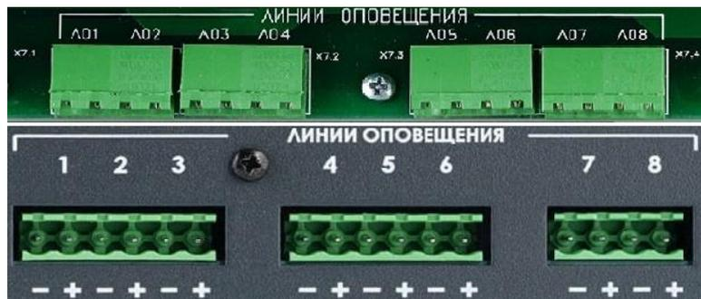
Рисунок 17. Клеммы для подключения речевых оповещателей (рупорных громкоговорителей).
