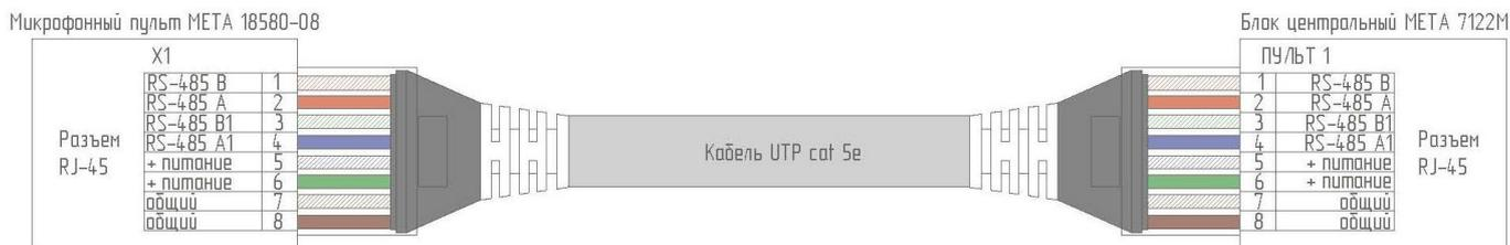
Рисунок 20. Схемы подключения кабеля от МП к ЦБ.
