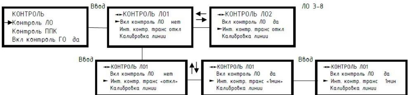
Рисунок 33. Установка интервалов контроля ЛО при трансляции.
