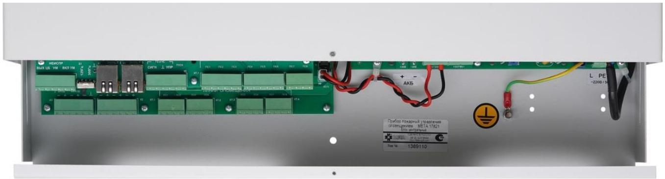
Рисунок 3. Клеммы (элементы коммутации) ЦБ МЕТА 17820/17821.
