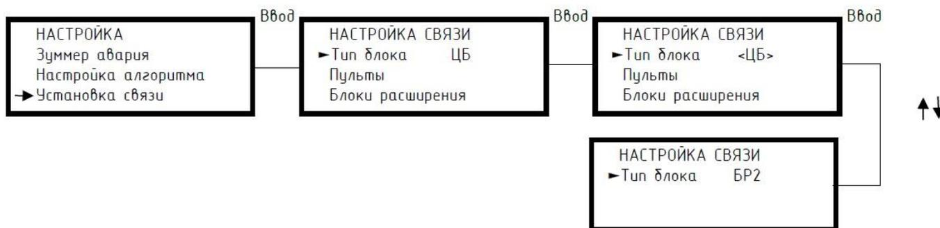
Рисунок 27. Установки режима работы прибора ЦБ или БР.
