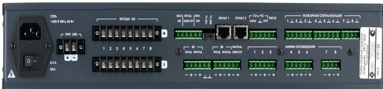
Рисунок 5. Задняя панель и расположение разъёмов ЦБ МЕТА 19830.
