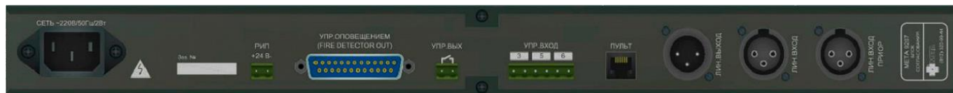
Рисунок 2. Элементы коммутации (клеммы и разъемы) БС МЕТА 9207.
