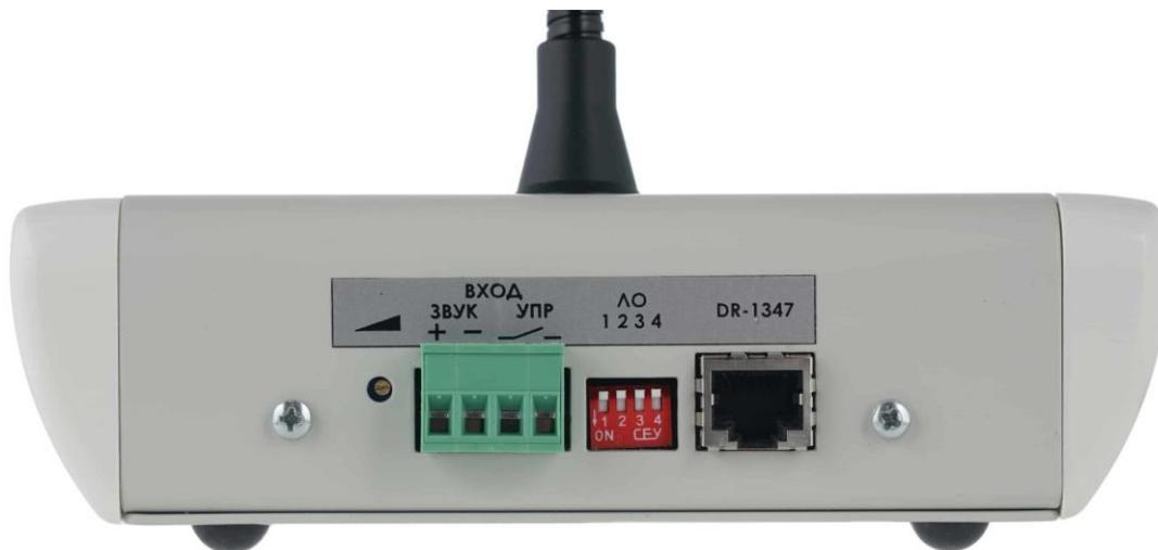
Рисунок 2. Внешний вид задней панели МП.
