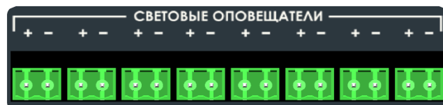
Рисунок 36. Клеммы «ВЫХОД СВЕТОВЫЕ ОПОВЕЩАТЕЛИ 1 – 8» для подключения табло МЕТА 7523 и МЕТА 7523 исп.1 к БС МЕТА 19560.
