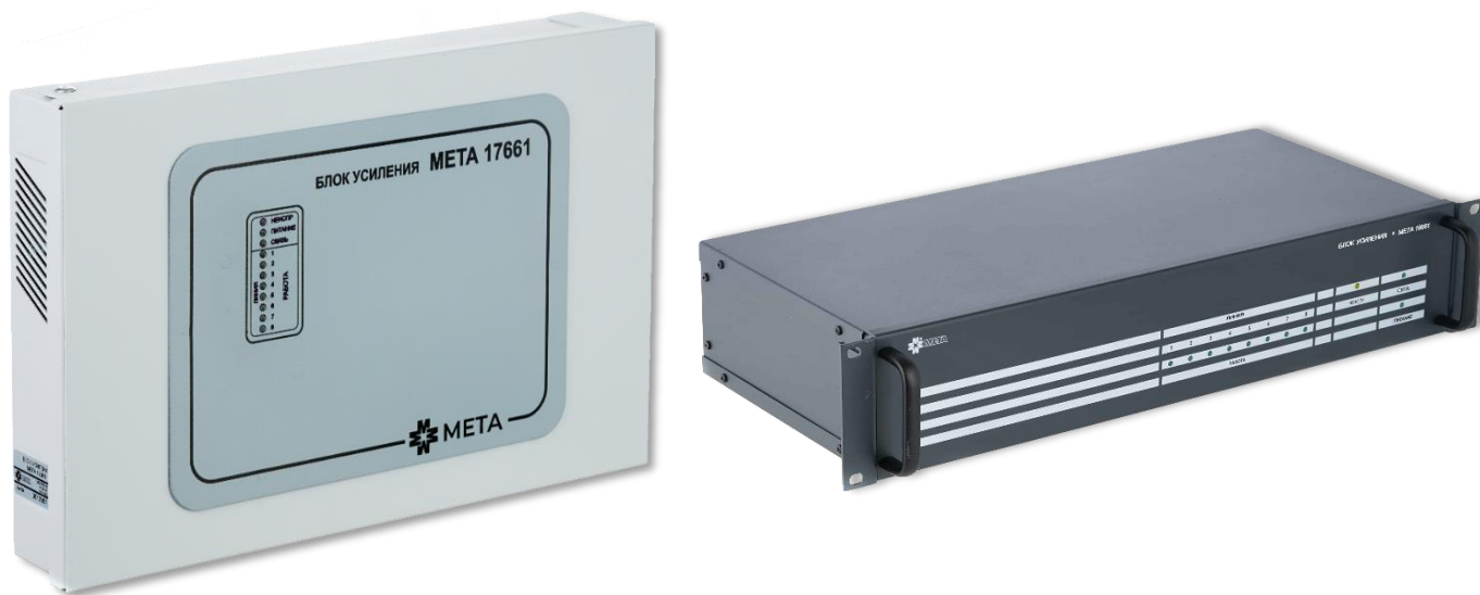
Рисунок 5. Внешний вид БУ META 17661 (слева) и БУ META 19661 (справа).
