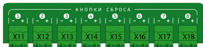
Рисунок 33. Клеммы «ВХОД КНОПКИ СБРОСА 1 – 8» для подключения УС МЕТА 7520 к БС МЕТА 17560.
