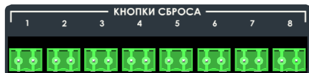
Рисунок 34. Клеммы «ВХОД КНОПКИ СБРОСА 1 – 8» для подключения УС МЕТА 7520 к БС МЕТА 19560.
