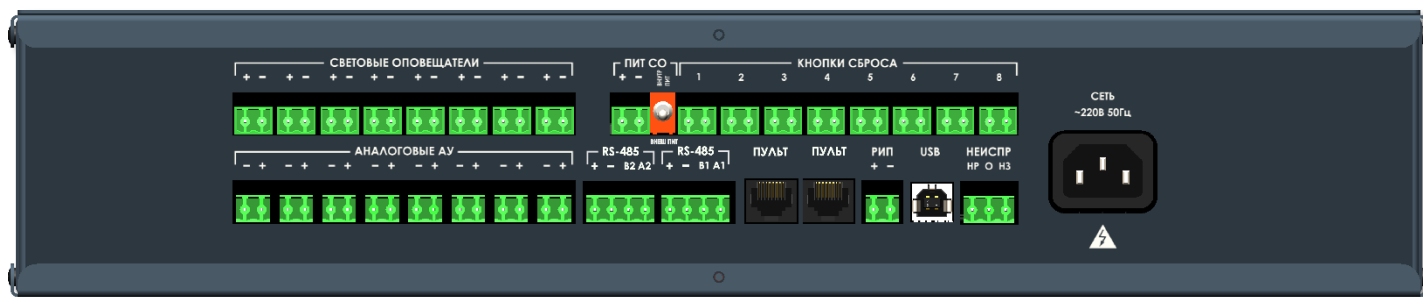
Рисунок 3. Элементы коммутации (клеммы/разъемы) БС META 19570.
