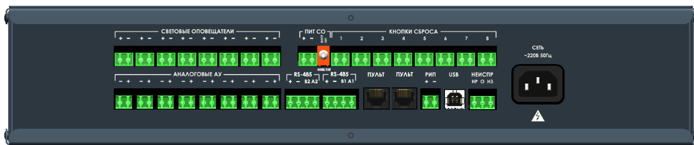
Рисунок 3. Элементы коммутации (клеммы/разъемы) БС META 19570.
